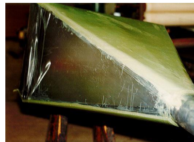
Bild 1: Handbelegen des Dornes mit Kautschukfolie
